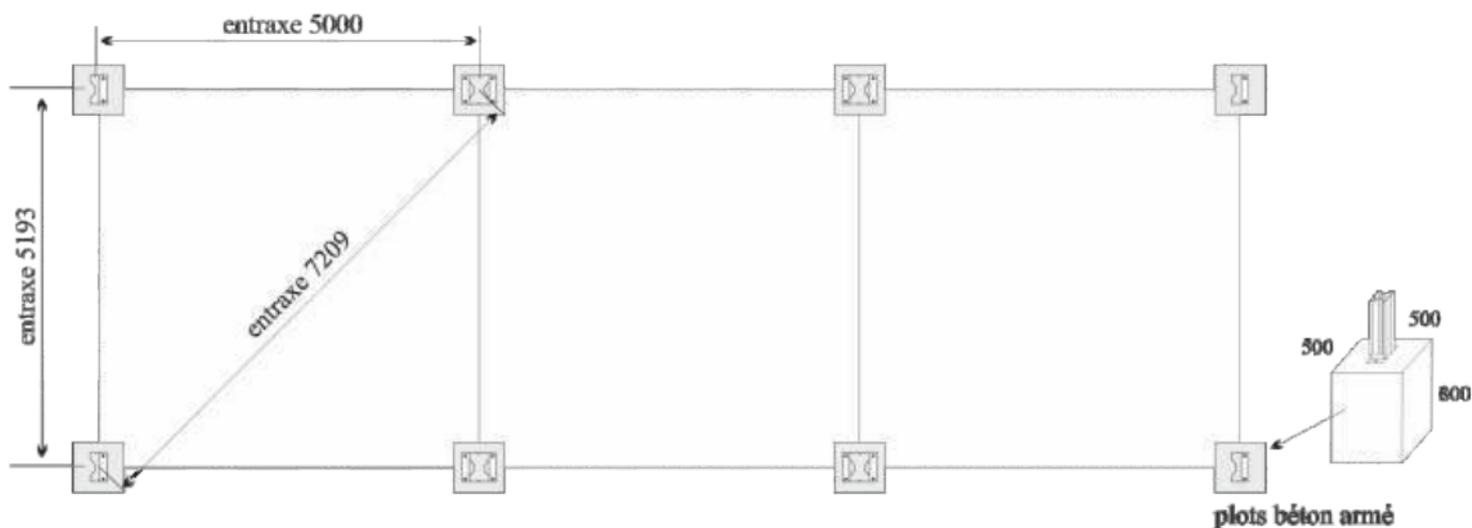
Si un portail doit être installé sur le pignon ou le long pan, prévoir une longrine de 300/200 sur une longueur de 2 fois le vantail
